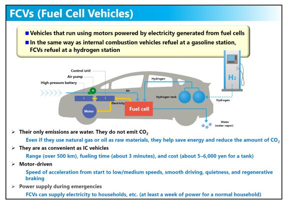
圖12 氫燃料電池車氫能轉換動力示意圖
