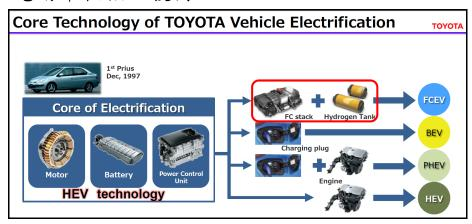
圖2 豐田電動車輛核心技術示意圖
