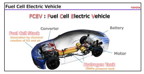
圖3 豐田氫燃料電池電動車示意圖
