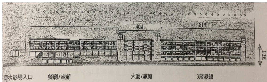
圖 1 投資計畫書規劃之量體為地上 3 層，地下 1 層，高度 13M（摘自 93.12 杉原海水浴場經營案投資執行計畫書，第 3-8 頁）
