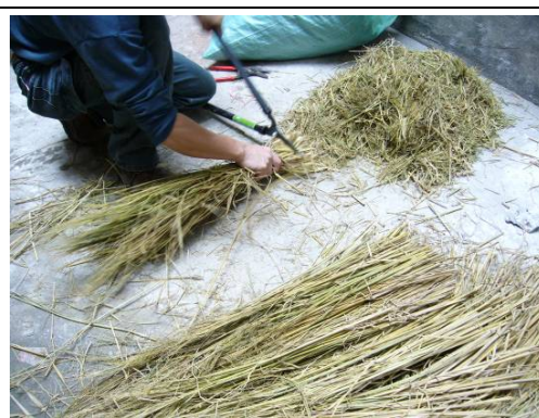
【照片 5-2-12】將稻梗剪成約 5 公分長度 970109
