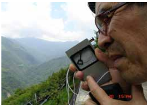
照片 C5 手持水準儀實測情形
