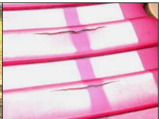
照片 2-5-6 綜合遊具踏階裂痕
