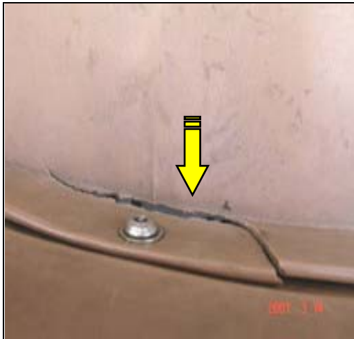
照片 1-8-1 綜合遊具筒狀滑道上緣破裂
