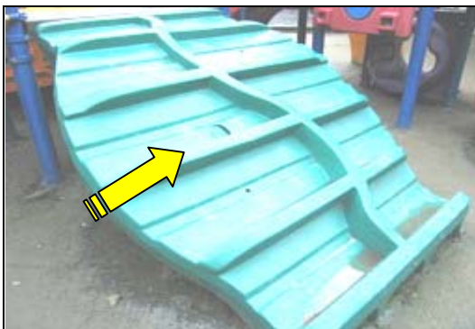
照片 2-11-1 綜合遊具踏階裂痕
