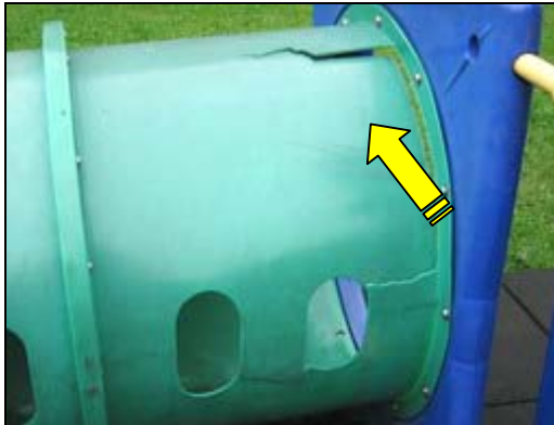
照片 2-7-2 隧道外殼破損
