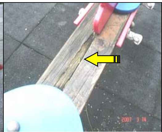
照片 1-9-2 翹翹板桿面木材腐蝕
