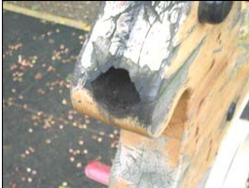
照片 2-4-2 木製搖搖馬前端破損
