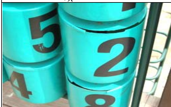
照片 2-13-3 綜合遊具平臺護欄之藍色元件破損
