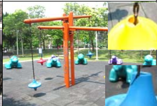
照片 2-5-8 盪盪飛碟座椅破損
