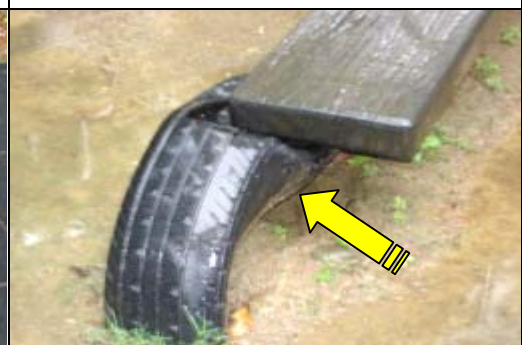
照片 3-11-8 翹翹板緩衝輪胎破損
