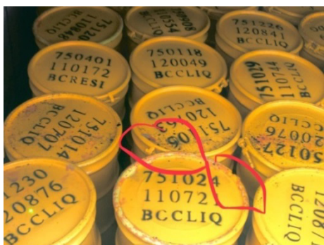
部分儲存桶位移和上下推擠，造成變形扭曲的情形
