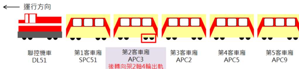
圖 15 第 2 客車廂 APC3 後轉向架 2 軸 4 輪出軌
