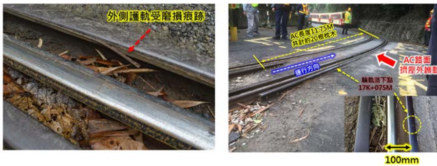
圖 6 SPC49 前轉向架 2 軸 4 輪出軌
