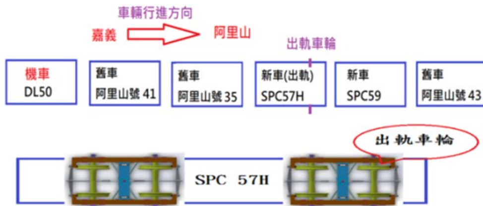
圖 2 新購車廂 SPC57H 前轉向架前 2 輪出軌
