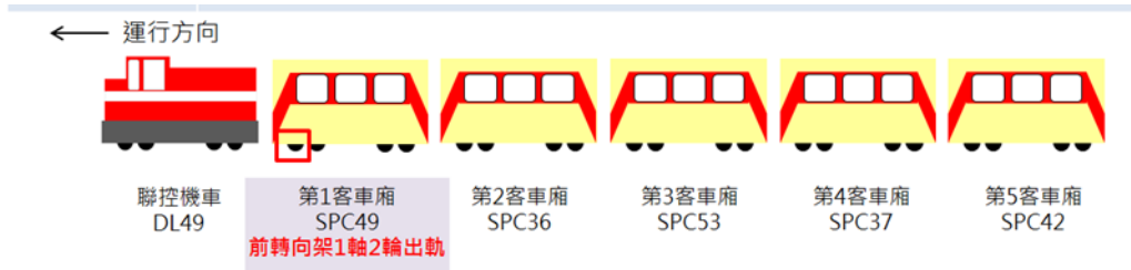
圖 11 第 1 客車廂 SPC49 前轉向架 1 軸 2 輪出軌
