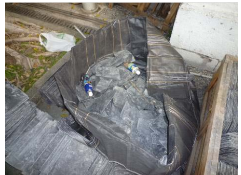
【照片 5-5-181】破損石板瓦 (98.11.28)
