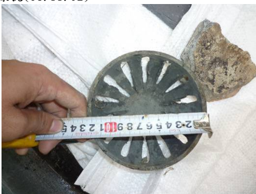
【照片 3-1-197】落水頭直徑 12.5 公分(98.11.02)
