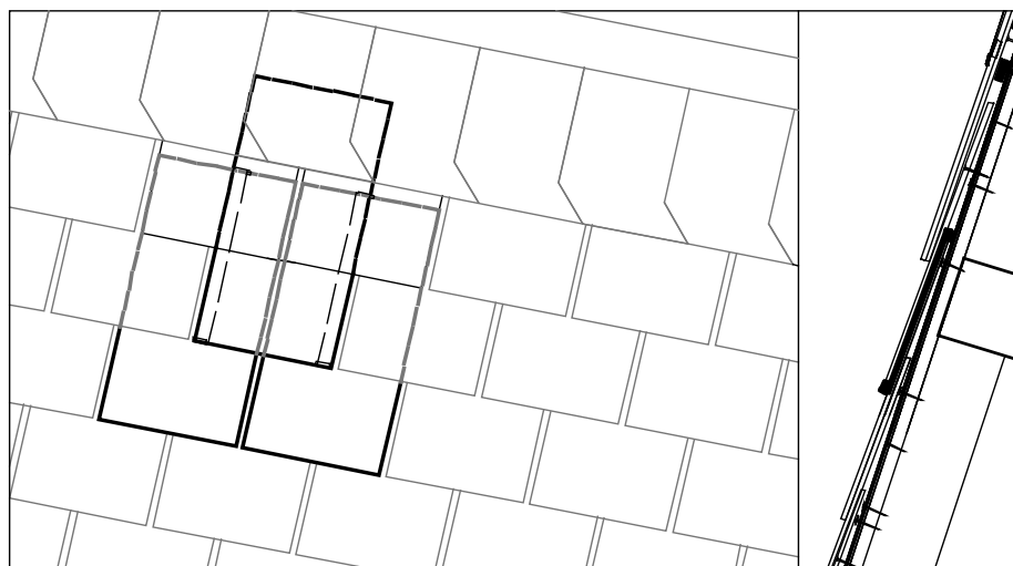
【圖 5-5-9】屋脊瓦覆蓋抽換示意圖，本研究繪製。
