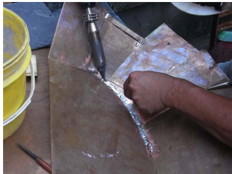
【相片 5-6-81】錫焊填縫固定(98.10.02)
