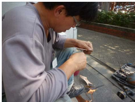
【照片 5-6-225】以尖嘴鉗彎摺半圓形倒鉤(98. 12. 11)
