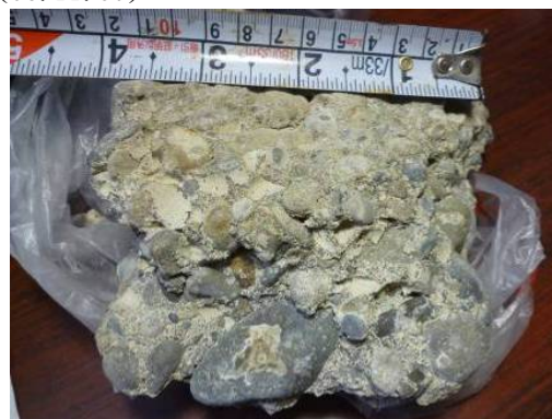
【照片 3-1-176】混凝土粗細骨材與水泥比例 (98. 11. 30)
