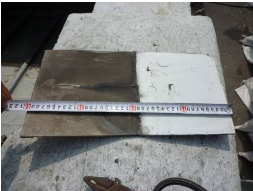
【照片 3-1-77】西翼 16 區屋面瓦長 40 公分 (98.08.27)
