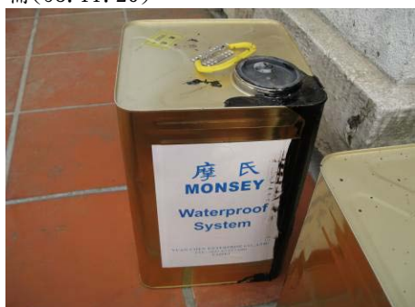
【照片 5-4-47】1. RA 防水(橡膠瀝青)(98.12.24)
