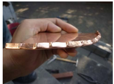
【照片 5-6-226】半圓形銅板彎摺後之細部(98. 12. 11)
