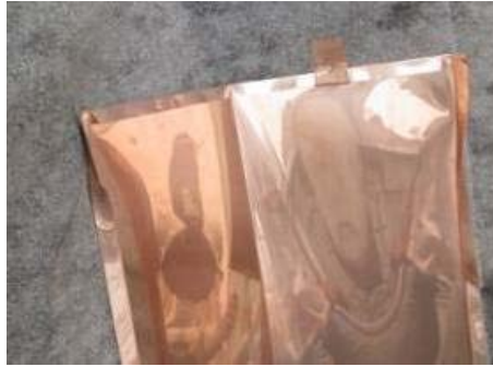
【相片 5-6-101】扳開銅板兩側反摺倒鈎(98.08.27)
