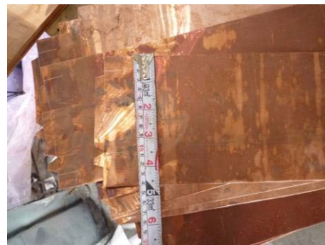
【照片 5-6-182】線板兩端收邊切口細 部(98.10.22)
