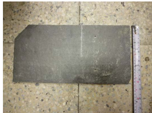
【照片 5-5-5】北翼與西翼屋脊瓦規格
