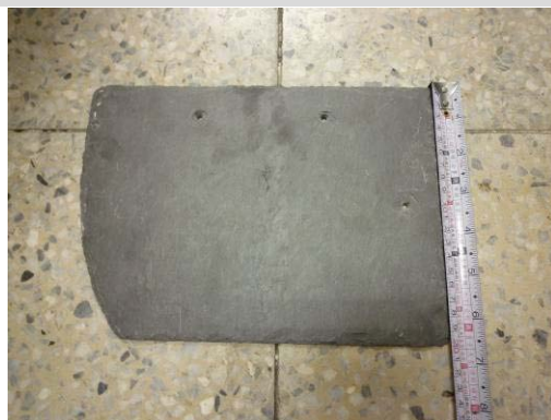
【照片 5-5-1】中央穹頂屋面瓦規格
