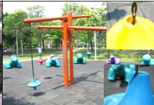
照片 2-5-8 盪盪飛碟座椅破損
