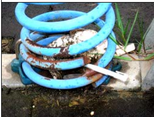
照片 2-17-3 翹翹板基座彈簧斷裂
