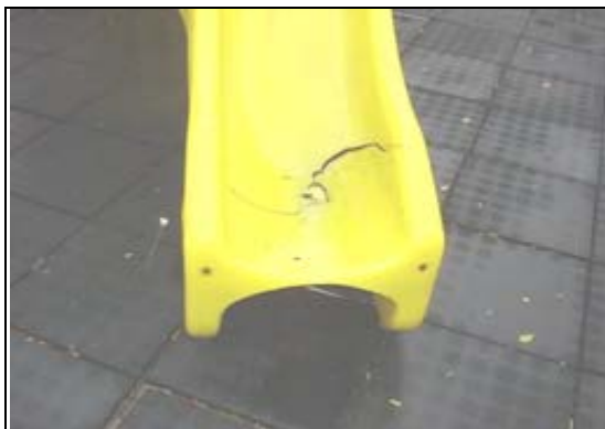
照片 3-10-1 綜合遊具之滑梯滑槽底端破損
