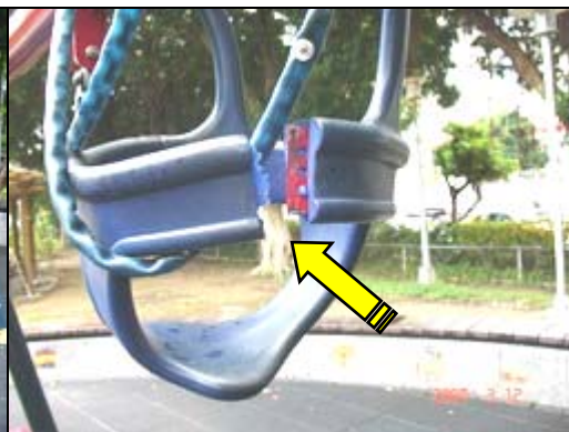
照片 1-2-2 鞦韆座椅斷裂近攝
