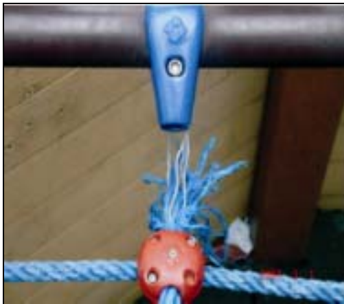
照片 1-3-2 綜合遊具網繩斷裂
