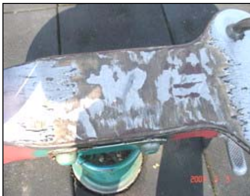
照片 1-7-2 搖搖馬座椅表面破損
