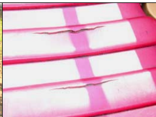
照片 2-5-6 綜合遊具踏階裂痕
