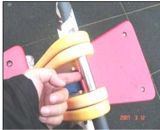
照片 1-5-5 翹翹板扶手鬆脫、晃動
