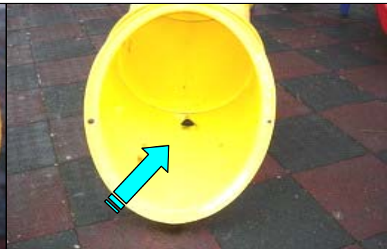
照片 3-11-2 綜合遊具之滑槽底端破損
