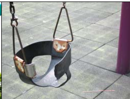
照片 2-14-2 鞦韆座椅破損
