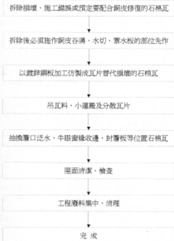
【圖 5-41】石棉瓦修復作業計畫程序（天下營造提供）
