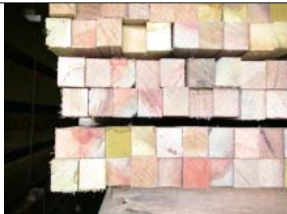
【圖版 5-29】乾燥室中 ACQ 處理後的木材
