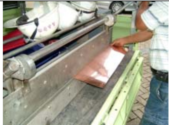
【圖版 5-136】 銅皮邊緣彎折（工具：折床）
