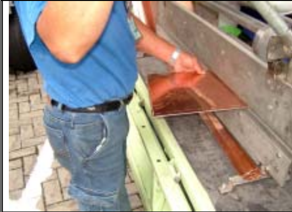
【圖版 5-139】彎折銅皮成型
