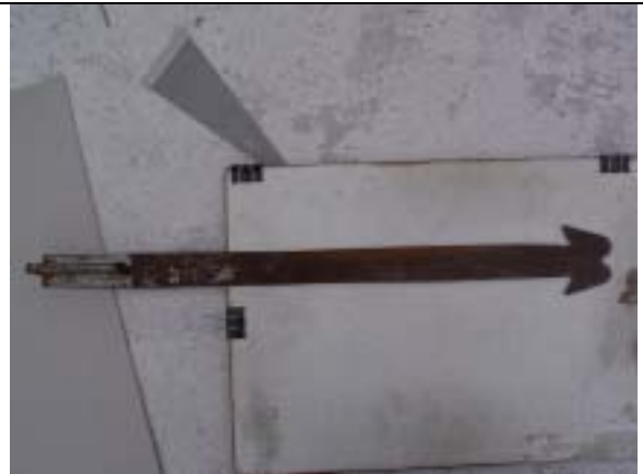
【圖版 5-202】自製拆瓦用具
