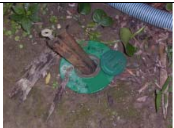
8.回測檢視，泥土地面塑膠蓋餌站 餌木已變色，需更換。 (2006-04-13，驗收前回測檢視)
