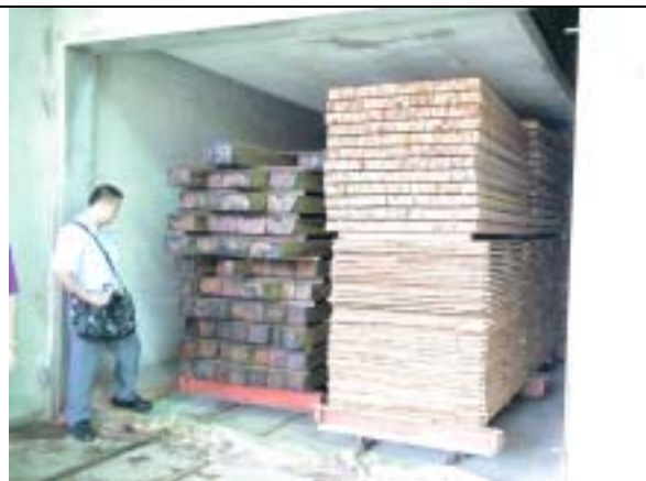
【圖版 5-29】乾燥室中 ACQ 處理後的木材
