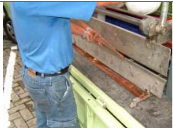
【圖版 5-138】 彎折銅皮成型
