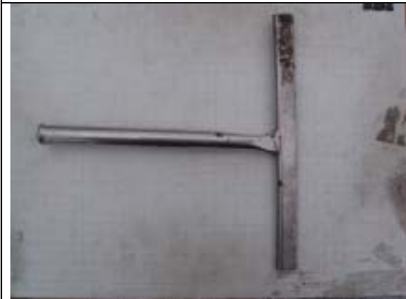
【圖版 5-205】自製拆瓦用具
