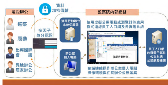
圖 8-21 遠距行動辦公系統架構圖
